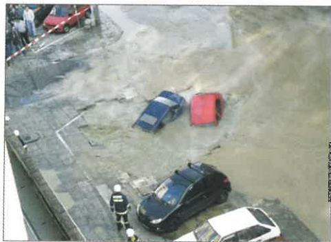
Rys. 4. Awaria rury przewodowej DN500, zniszczenie samochodów zaparkowanych w pobliżu miejsca awarii Fig. 4 Failure of a DN 500 pipeline, destruction of cars parked near the failure
