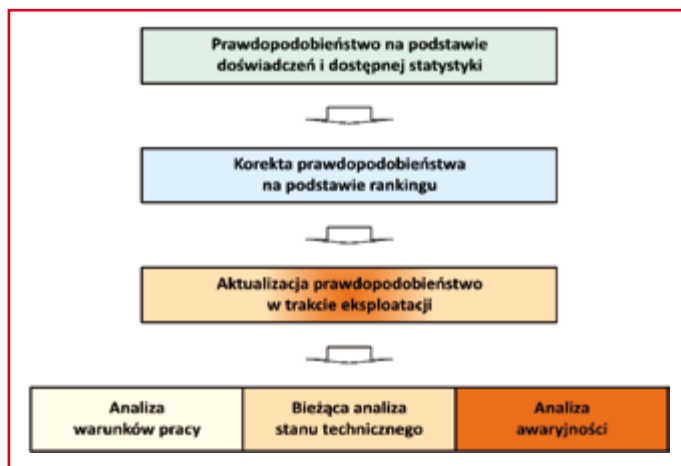
Rys. 7. Sposób określenia prawdopodobieństwa uszkodzenia.
