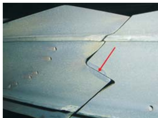
Rys. 2. Odształcenie plastyczne w miejscu kontaktu łopatek
