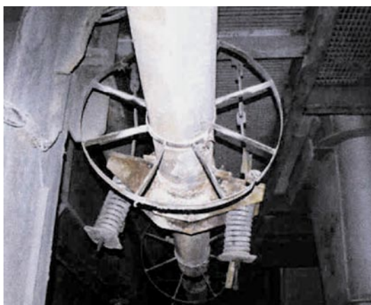
Rys. 11. Luźna i pokrzywiona obejma pozioma zamocowania dwukolumnowego
