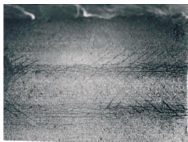
Rys. 3c. Linie poślizgu na powierzchni wewnętrznej
