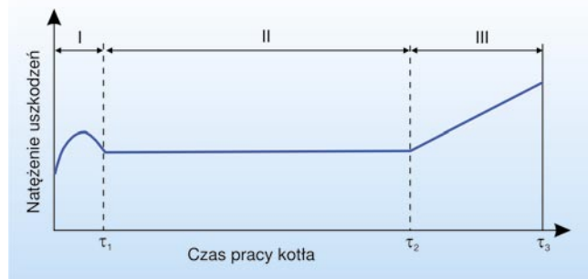
Rys. 2. Teoretyczna zależność liczby uszkodzeń kotłów od czasu pracy
