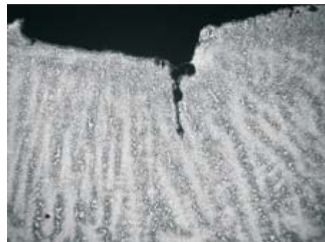
Rys. 10. Pęknięcie widoczne na przekroju poprzecznym trójnika (pow. 4x), widoczny dendryt
