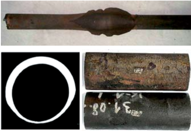
Rys. 14. Uszkodzona rura parownika
