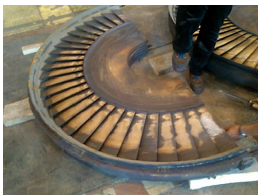
Rys. 4. Tarcza kierownicza K25 i osad z niej pobrany
