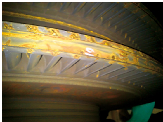
Rys. 5. Wirnik turbiny i osad pobrany ze stopnia nr 10
