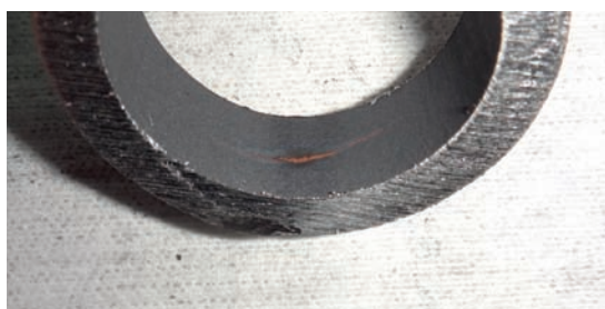
Rys. 6. Pęknięcie na wskroś – powierzchnia wewnętrzna rury
