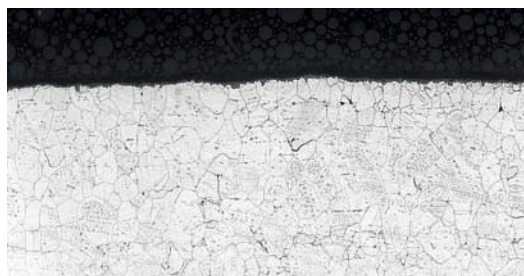
Rys. 2. Powierzchnia zewnętrzna wężownicy p.p. III° (stal TP310HCBN)
