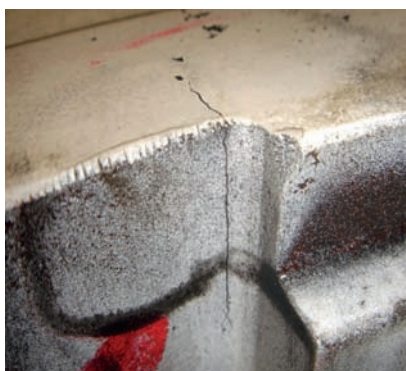
Rys. 3. Pęknięcie tarczy nasadzonej w rowku wpustowym
