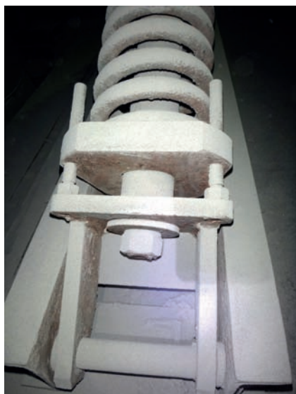
Rys. 2. Zamocowania 10.2G8 oraz 10.1G9 – pochylone belki nośne na skutek zatarcia trzpienia
