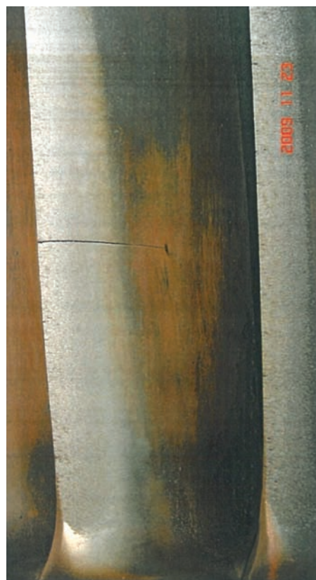
Rys. 6. Łopátka pęknięta przy stopce, kraweź wylotowa, pęknięcie termiczne
