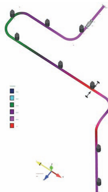
Rys. 2. Wynik symulacji naprężeń (stosunek naprężeń obliczeniowych do dopuszczalnych). Przekroczenie poziomu naprężeń dopuszczalnych na odcinku prostym ze względu na uszkodzenie zamocowania i/lub kolizję (ograniczenie ruchu) – sytuacja hipotetyczna
