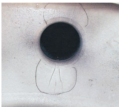
Rys. 5. Pęknięcie w okolicy otworu ociążającego na stopniu wirnika
