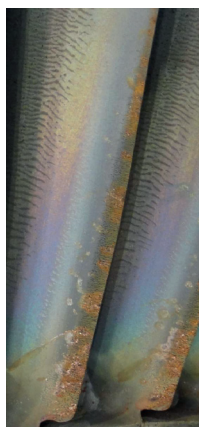
Rys. 5. Uszkodzenia łopatek turbiny typu 125 MW
