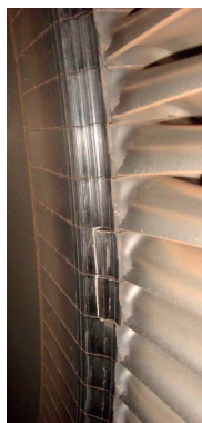
Rys. 2. Uszkodzenia stopek łopatek turbiny typu 120 MW
