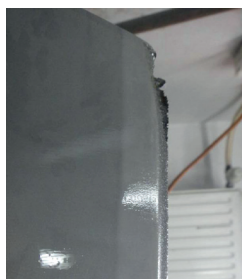
Rys. 7. Erozja ostatnich stopni wirnika NP, wirnik turbiny klasy 200 MW
