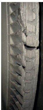
Rys. 1. Uszkodzenia bandaża i łopatek turbiny typu 25 MW
