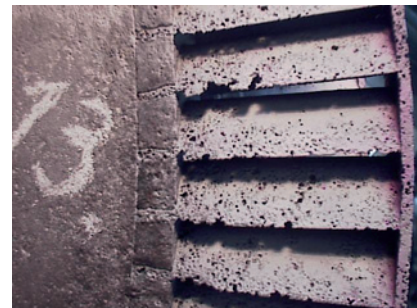
Rys. 4. Uszkodzenia łopatek turbiny typu 25 MW
