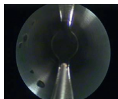
Rys. 29. Wady na powierzchni otworu centralnego wirnika generatora
