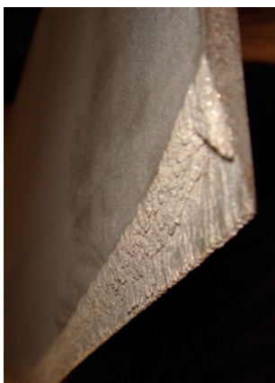
Rys. 6. Erozja ostatnich stopni wirnika NP, wirnik turbiny klasy 200 MW
