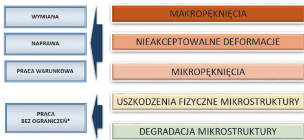
Rys. 6. Identyfikacja różnych objawów degradacji własności materiału
