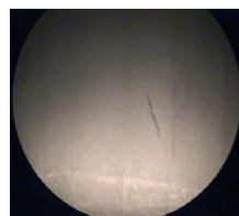
Rys. 30. Wskazania na powierzchni otworu centralnego wirnika turbiny typu 25 MW
