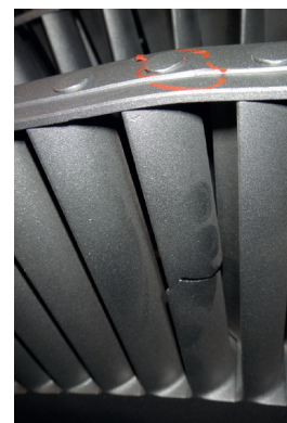
Rys. 13. Pęknięcia łopatki, wirnik turbiny 50 MW
