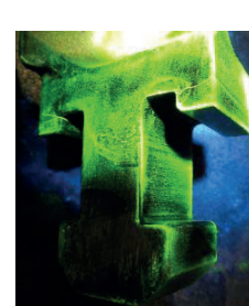
Rys. 14. Pęknięcia stopki łopatki, wirnik turbiny 75 MW
