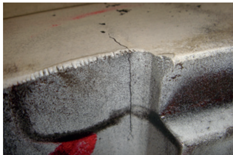
Rys. 3. Pęknięcie wpustu tarczy nasadzonej turbiny typu 50 MW
