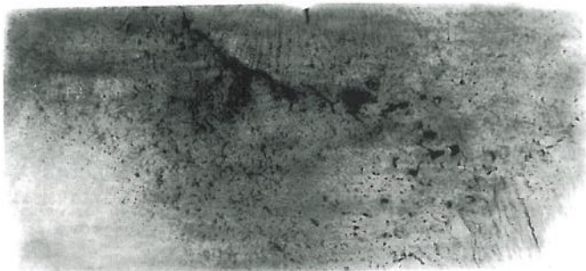
Rys. 3. Makrostruktura materiału pod siedliskiem grzyba zaworu szybkozamkającego; widoczne: struktura dendrytyczna, pory skurczowe oraz pęknięcia odlewnicze i eksploatacyjne; trawiono odczynnikami Jacewicza (na gorąco)
