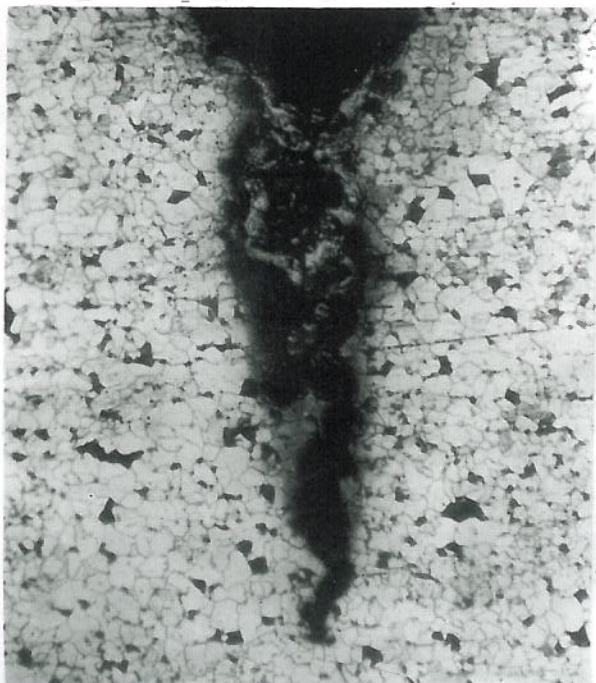
Rys. 3. Typowe pęknięcia w postaci klina wypełnionego produktami korozji (pow. 100x)
