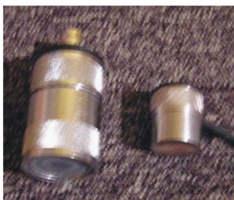
Rys. 3. Sondy LRM-EMAT-PR do pomiaru grubości ścianek rur kotłowych
