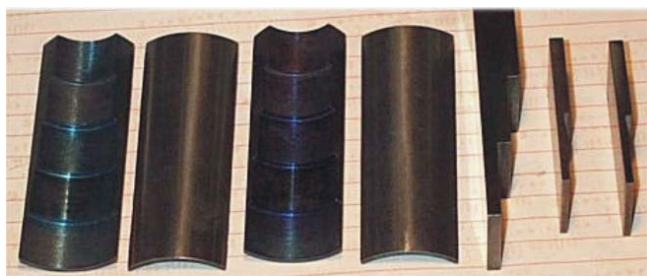
Rys. 4. Próbkki odniesienia (wzorce pomiarowe) LRM-EMT- ST
