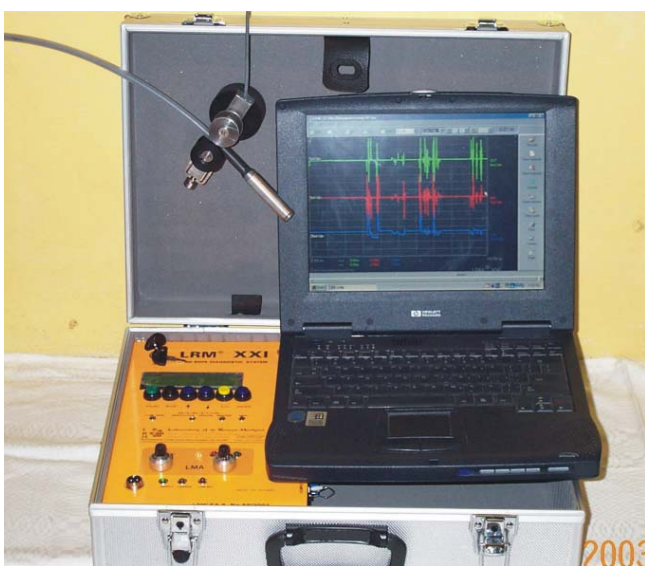
Rys. 8. Polski System Diagnostyczny LRM®-XXI do badania rur stalowych
