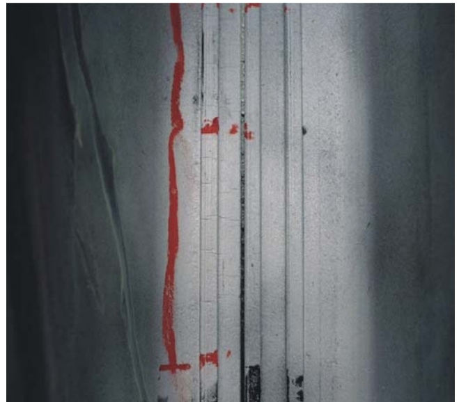
Rys. 17. Pęknięcia ujawnione na piście tarczy nasadzonej
