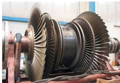
Rys. 2. Wirnik NP turbiny 200 MW, modernizacja Alstom Power
