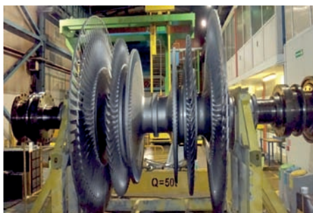
Rys. 4. Wirnik NP. turbiny 200 MW, modernizacja Westinhouse
