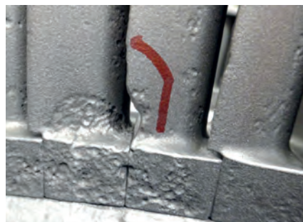
Rys. 15 Korozja postojowa. Turbina 55 MW, wirnik turbiny
