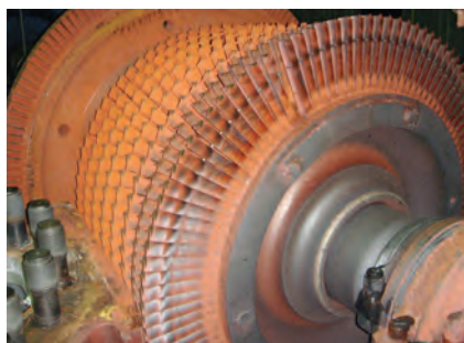
Rys. 12 Korozja postojowa. Turbina 5 MW, wirnik turbiny
