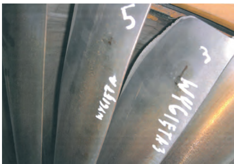
Rys. 2. Zdeformowane łopatki ostatniego stopnia wirnika
