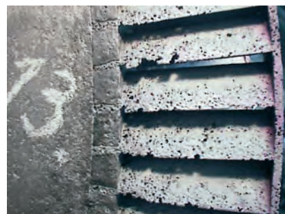
Rys. 13 Korozja postojowa. Turbina 25MW, wirnik turbiny
