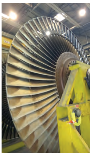
Rys. 9. Ubytki erozyjne na krawędziach wylotowych. Turbina 200 MW, wirnik NP
