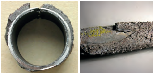
Rys. 8. Korozja wysokotemperaturowa – obustronne pocienienie ścianki węzownicy aż do perforacji
