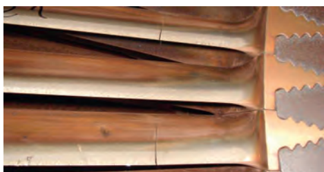
Rys. 3. Pęknięcia na krawędziach wylotowych łopatek
