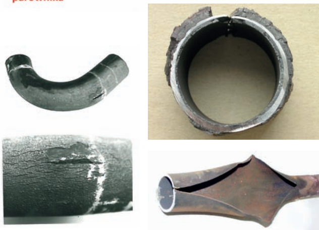
Rys. 3. Zwiększona grubość warstwy tlenków i osadów na powierzchni węzownic
