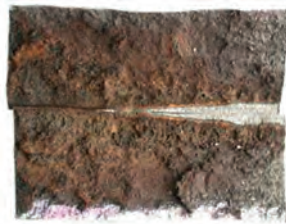
Silnie skorodowany przelom – długotrwały proces niszczenia
