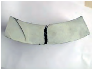
Pęknięcie „główne” przechodzące na wskroś ścianki
