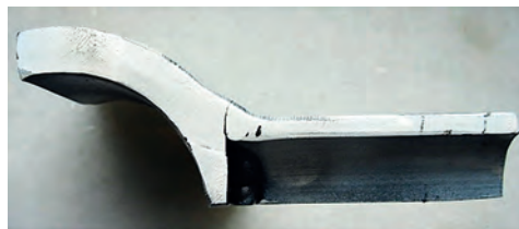
Rys. 2. Pęknięcie spoiny łączącej węzownicę z kolektorem
