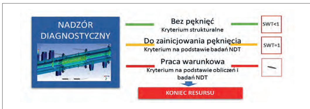
Rys. 6. Wykorzystanie zapasu trwałości elementów krytycznych bloku w zależności od trybu jego pracy oraz strategii produkcyjnej
