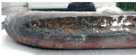
Rys. 13. Uszkodzenie erozyjne węzownicy przegrzewacza grodziowego
