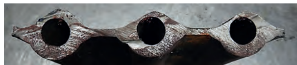
Rys. 4. Abrazyjne ubytki ścianki w wyniku abrazyj
