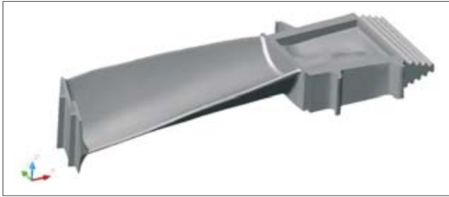
Rys. 3. Model geometryczny łopatki drugiego stopnia turbiny gazowej
