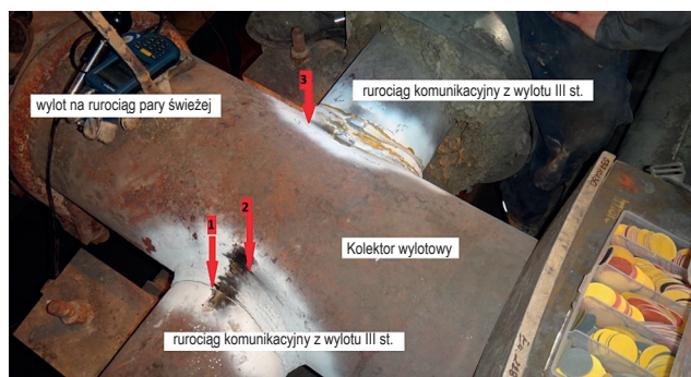
Rys. 2. Kolektor wylotowy pary świeżej – uszkodzenia
