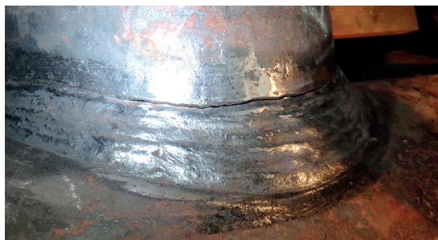
Rys. 3. Kolektor wylotowy pary świeżej – pęknięcie nr 1, na wskroś grubości ścianki
