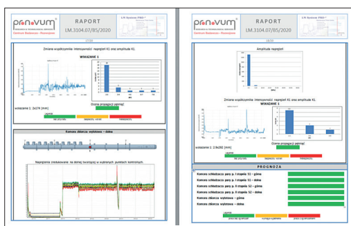
Rys. 5. LM System PRO+® – okresowy raport z bieżącej oceny bezpieczeństwa pracy elementu z akceptowalnymi, według kryteriów mechaniki pęknięcia, wskazaniami
