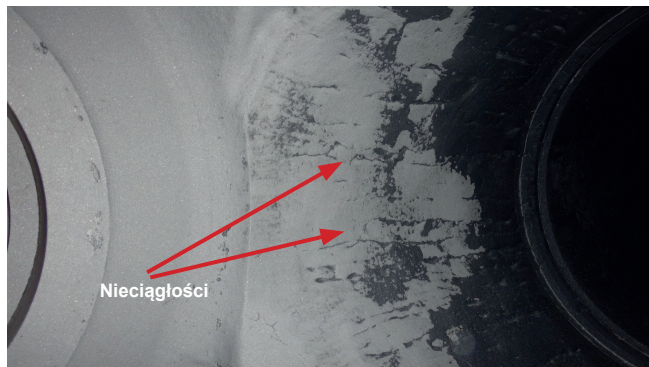
Rys. 6. Potencjalne nieciągłości sąsiadujące z obszarem nieprzygotowanym do badań
