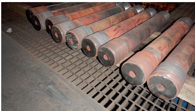
Rys. 14. Śruby szpilkowe kadłuba zewnętrznego przygotowane do badań UT
