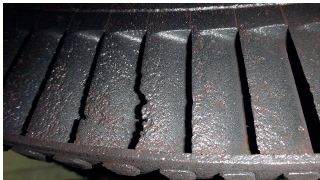
Rys. 1. Przykład ubytku materiału łopatek w wyniku korozji postojowej
