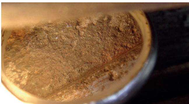
Rys. 10. Produkty korozji oraz osady obecne we wrębie łopatkowym
