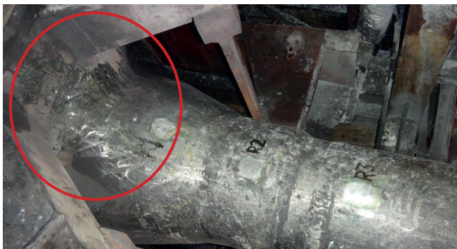
Rys. 4. Niedoszlifowane obszary elementu przekazanego do badań
