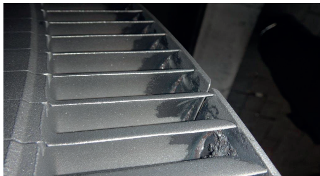
Rys. 7. Osady pozostawione pod bandażami stopnia łopatkowego
