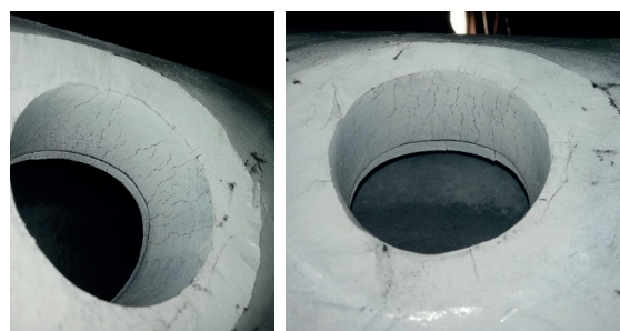
Rys. 6. Schładzacz II° – stan po badaniach MT
