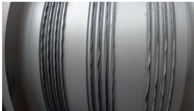
Rys. 17. Powyginane blaszki uszczelnień podczas piaskowania
