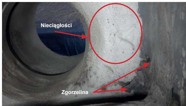
Rys. 5. Obszar nieciągłości w pobliżu pozostawionej zgorzeliny
