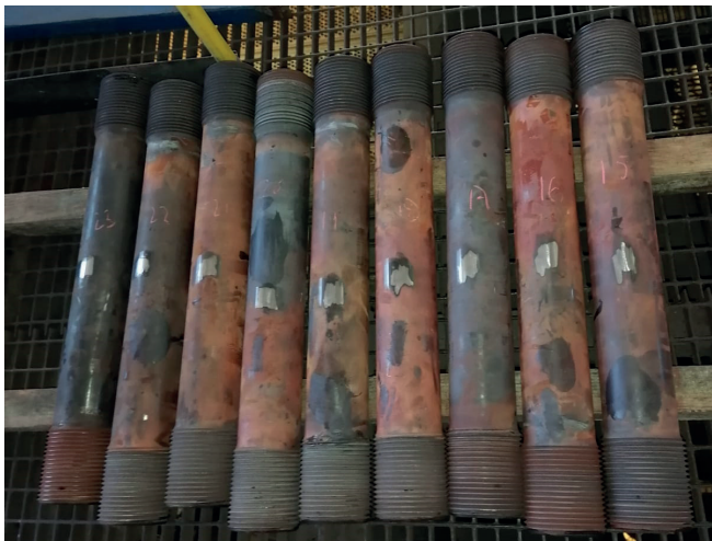
Rys. 15. Śruby szpilkowe kadłuba zewnętrznego przygotowane pod pomiar twardości
