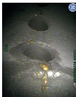
Rys. 2. Kolektor wylotowy pary świeżej – uszkodzenia
