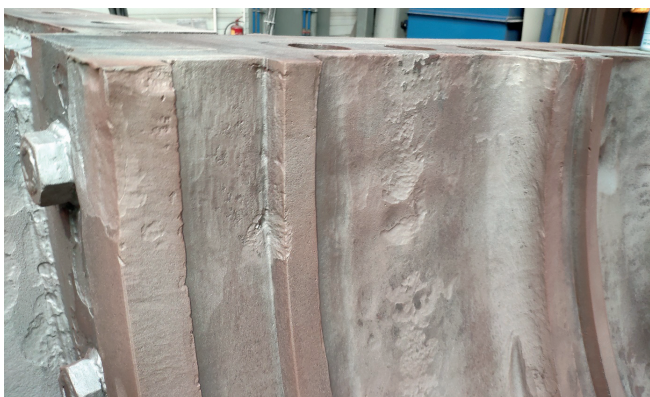
Rys. 16. Pozornie przygotowana powierzchnia kadłuba
