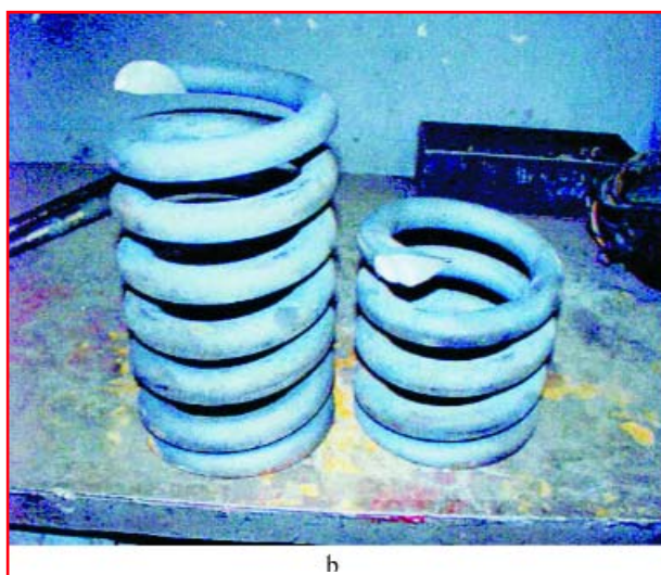
Rys. 21. Uszkodzenie zawieszenia dwukolumnowego sprężynowego a – zablokowane zwoje b – złamana sprężyna
