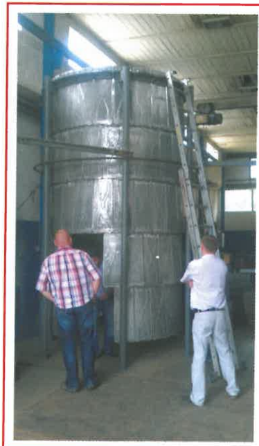
Rys. 12. Vortex (nurnik) przeznaczony dla kotła nr 4 o nowej konstrukcji składającej się z płyt segmentowych.
