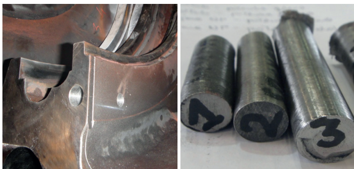
Rys. 7 Wycinki materiału do badań specjalnych wyrepanowane z kadłuba turbiny
