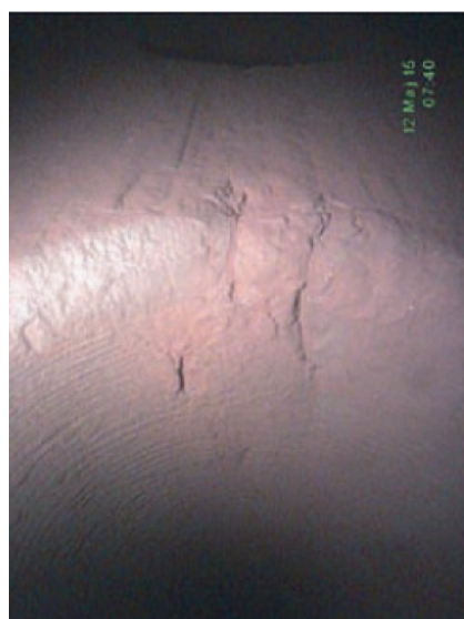
Rys. 6 Pęknięcia krawędzi otworu w komorze wylotowej przegrzewacza pary świeżej jako rezultat zwiększonej liczby i prędkości uruchomień bloku ze stanu gorącego. Źródło: opracowanie własne
