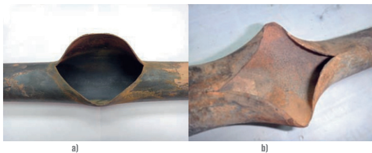
Rys. 3 Zakończenia cyrkulacji czynnika w kotle – przegrzanie rur przegrzewacza pary. Źródło: opracowanie własne
