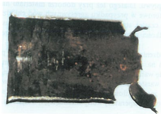
Rys. 1. Typowe uszkodzenie erozyjne wlotów rurek mosiężnych
