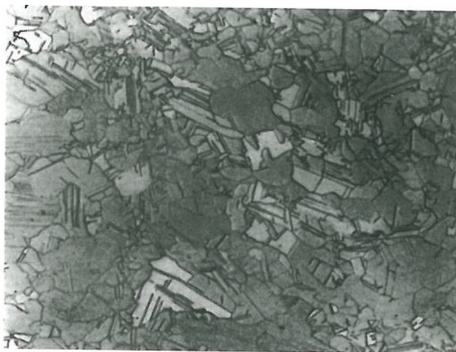
Rys. 3. Struktura stopu w okolicy ubytków korozyjnych (pow. 500x)
