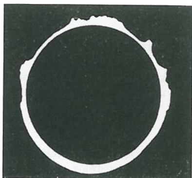
Rys. 2. Charakter ubytków na górnym obwodzie rurki (pow. 2x)
