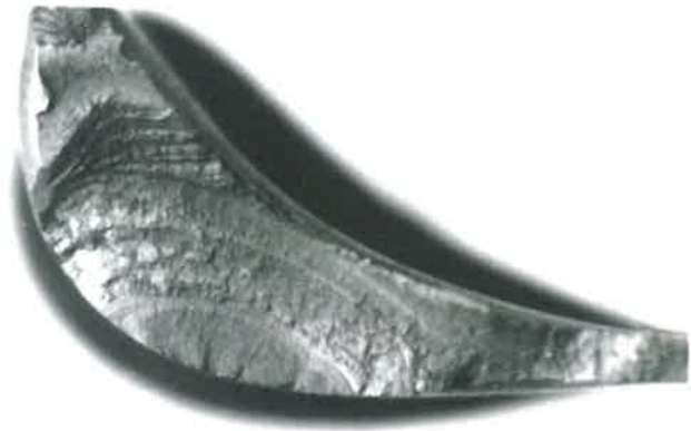
Rys. 10. Pęknięcia wskutek zmęczenia korozyjnego; turbina o mocy 70 MW Przyczyna uszkodzenia: nieodpowiednia czystość pary oraz nadmierne amplitudy drgań
