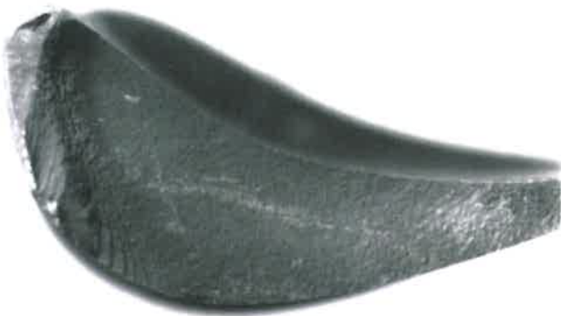
Rys. 9. Pęknięcie wskutek korozji naprężeniowej; stopień przed upustem; turbina o mocy 55 MW Przyczyna uszkodzenia: nieodpowiednia czystość pary oraz nadmierne naprężenia statyczne
