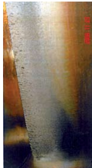
Rys. 5. Erozja krawędzi wylotowej
