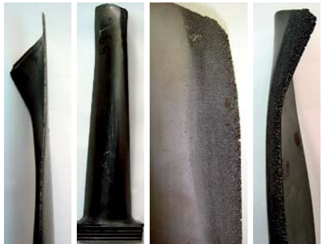
Rys. 6. Erozja – krawędzie wlotowe
