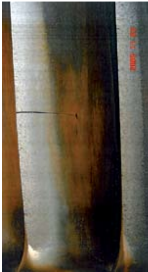
Rys. 4. Łopátka pęknięta przy stopce, krawędź wylotowa, pęknięcie termiczne
