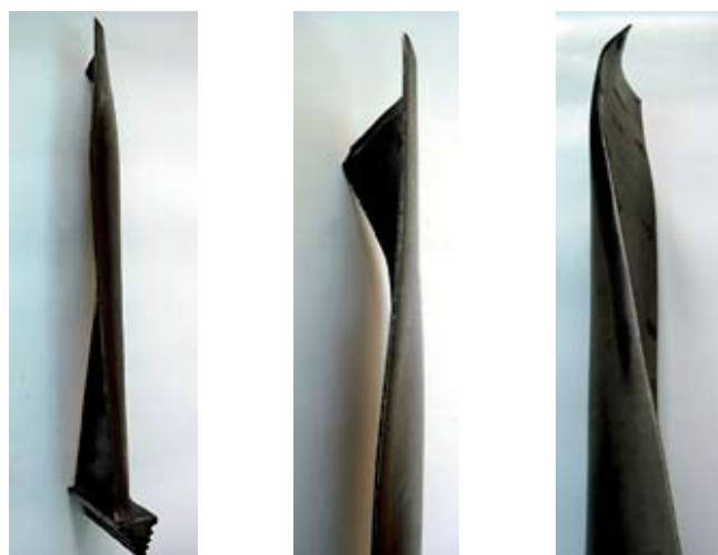
Rys. 3. Odształcenie cieplne łopatek
