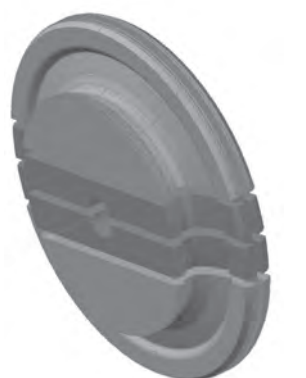
Rys. 11. Sposób pocięcia pierwszego stopnia wirnika SP, turbiny 200 MW
