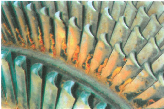
Rys. 5. Znaczące ubytki korozyjne na wylotowych krawędziach łopatek (czas pracy do powstania uszkodzenia kilkanaście dni)
