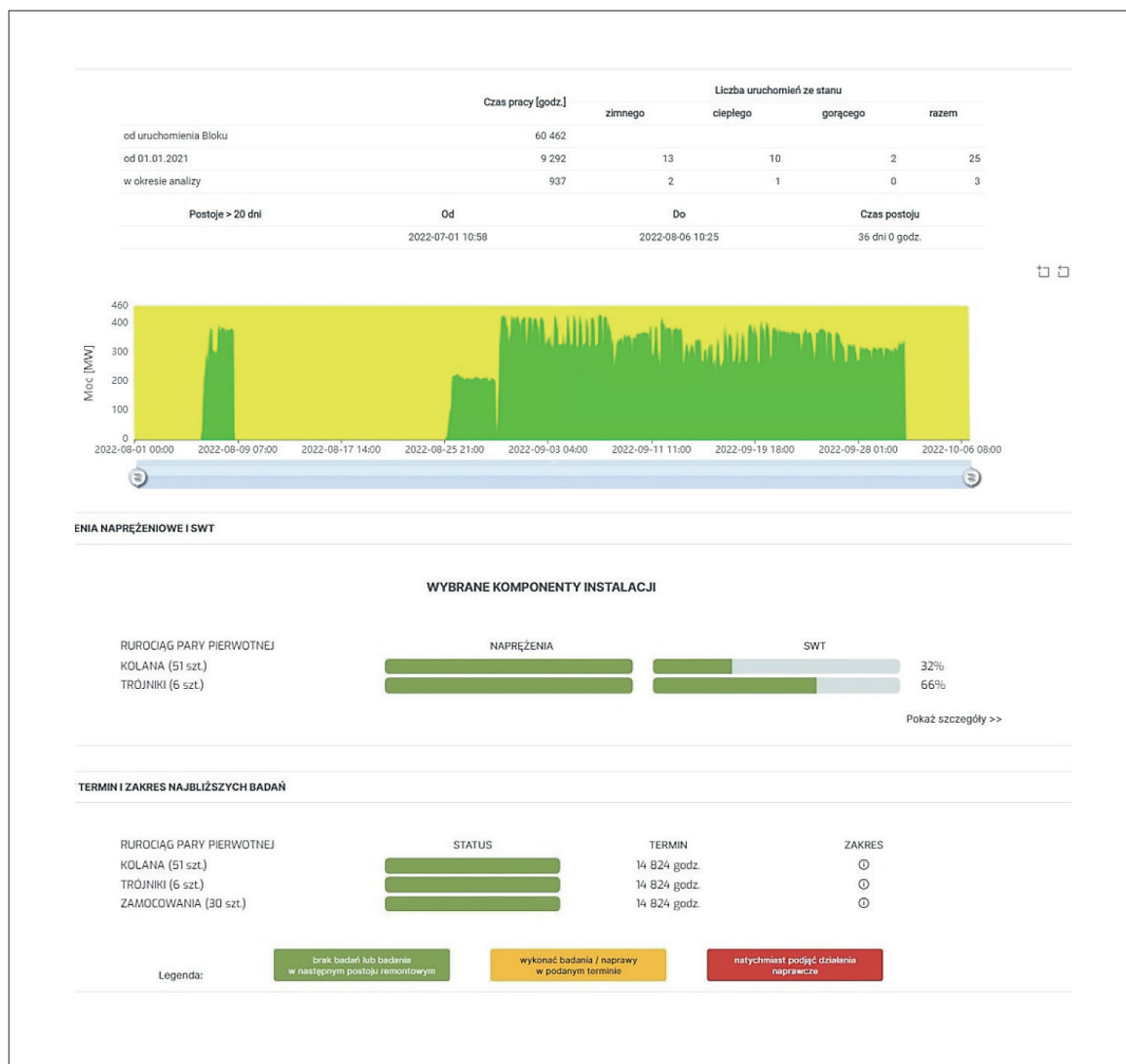
RYS. 5 Przykładowy interfejs programu do zdalnego nadzoru rurociągów parowych
