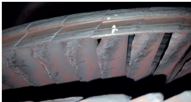
Rys. 2. Przykład przytarcia łopatek i bandaży
