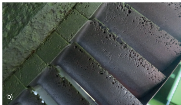
Rys. 6. Przykład korozji postojowej i degradacji materiału łopatek wirnikowych (a) oraz tarczy wirnikowej (b)
