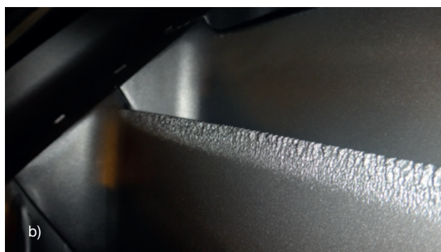
Rys. 4. Przykłady erozji na krawędziach wylotowych łopatek
