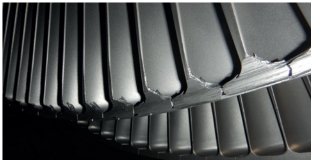
Rys. 1. Przykład przytarcia łopatek
