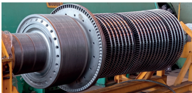
Rys. 16. Wirnik po remoncie
