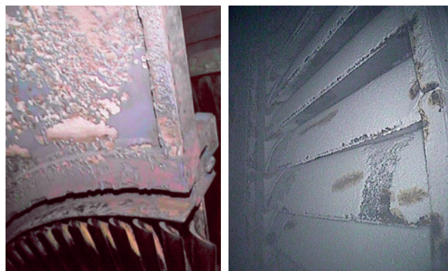
Rys. 3. Osady w układzie przepływowym
