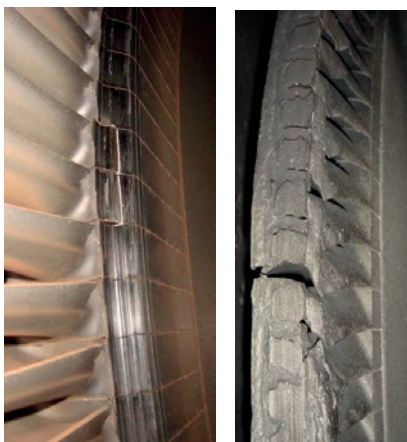
Rys. 5. Przytarcia w układzie przepływowym
