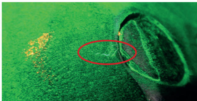
Rys. 10. Pierwszy stopień wirnika SP. Tarcza od strony wlotowej – wskazanie 3 mm
