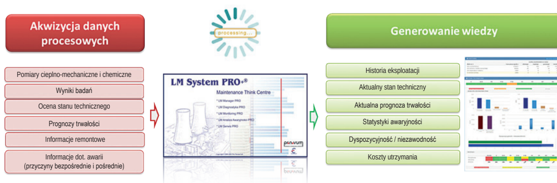
Rys. 2. Zdalna diagnostyka w formie wieloletniego serwisu LM Serwis PRO+®, zapewniająca automatyczną aktualizację oceny stanu technicznego i prognozy trwałości, zrealizowana na Platformie LM System PRO+®
