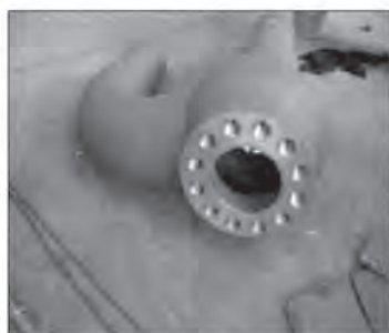
Рис. 7. Ремонт коробок клапанов
