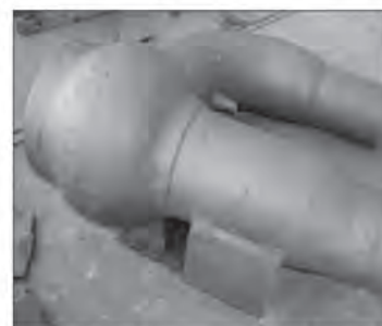
Рис. 7. Ремонт коробок клапанов
