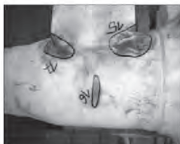
Рис. 5. Восстановление элементов турбины из литой стали. Выборка металла ВД после удаления трещин
