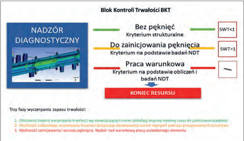
Rys. 1. Blok Kontroli Trwałości – wykorzystanie zapasu trwałości
