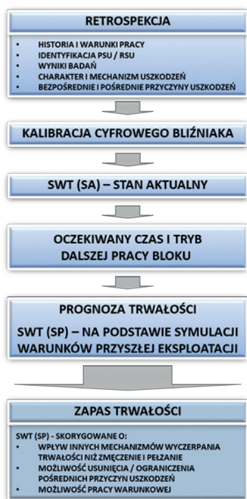
Rys. 7. Schemat procesu określania zapasów trwałości elementów krytycznych bloków/urządzeń energetycznych w przedłużonym czasie eksploatacji i dowolnym trybie pracy [14]
