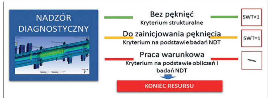
Rys. 10. Określanie zapasów trwałości elementów krytycznych urządzeń do pełnego wyczerpania ich trwałości z uwzględnieniem kontroli propagacji pęknięć (według kryteriów mechaniki pęknięcia)
