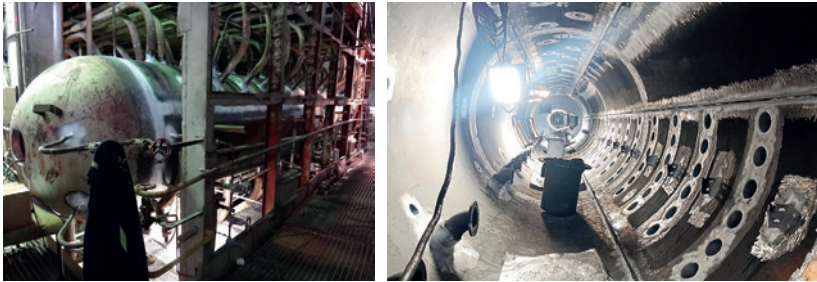
Rys. 2. Powierzchnia zewnętrzna i wewnętrzną walczaka przygotowane do badań magnetyczno-proszkowych
