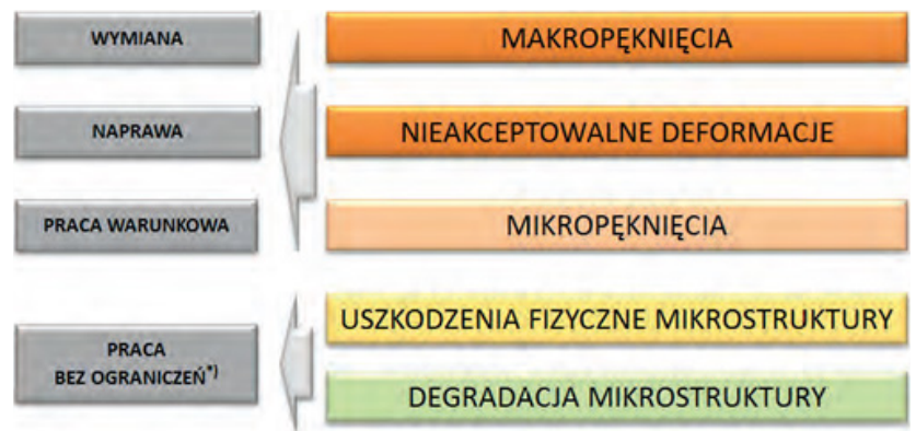
Rys. 4. Postępowanie związane z identyfikacją różnych objawów wyczerpania trwałości elementu. *) praca bez ograniczeń w okresie do następnego badania i oceny stanu technicznego
