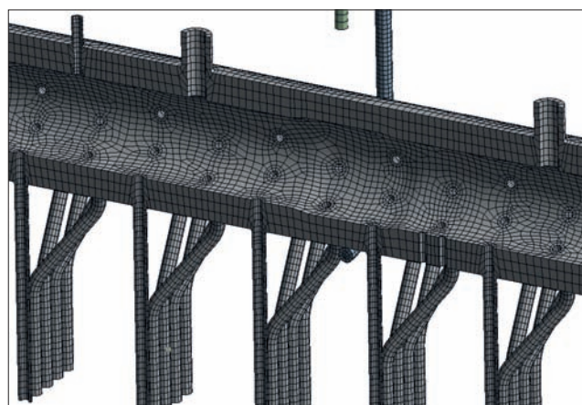
Rys. 3. Siatka elementów skończonych na fragmencie komory przegrzewacza
