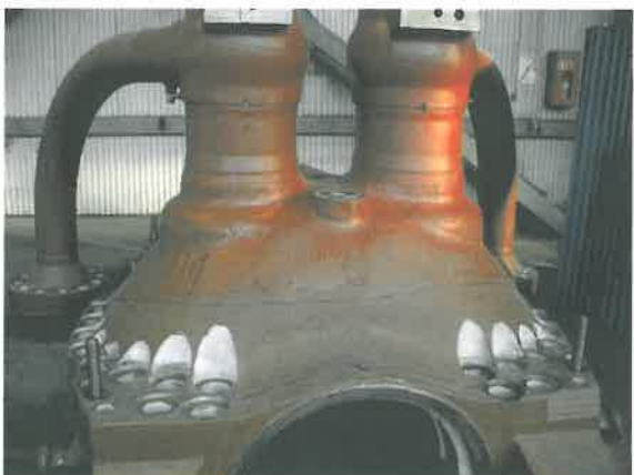
Po obróbce cieplnej i mechanicznej, przygotowany do transportu
