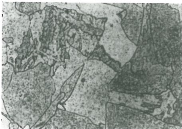
Rys. 2. Struktura materiału kadłuba w stanie poeksploatacyjnym w sąsiedztwie strefy naprawionej przez spawanie (rys. 1a), trawiono nitałem, pow. 200x
