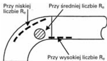
Rys. 5. Miejsca występowania FAC w zależności od wartości liczby Reynoldsa [2]
