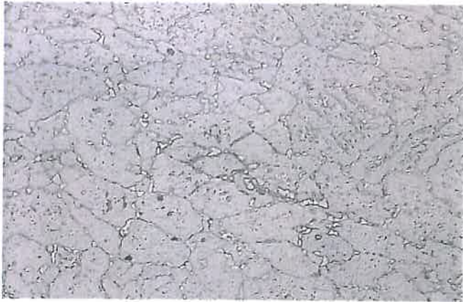
Rys. 11. Struktura ferrytyczno-bainityczną o wielkości ziarna ferrytu 8/9 i bainitu 7/9 wg PN-84/H-04507; wydzielenia węglików wewnątrz i po granicy ziaren
