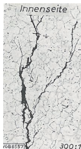
Rys. 2. Początkowa faza propagacji pęknięć po granicach ziarna [5]
