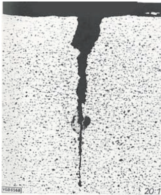
Rys. 4. Pęknięcia główne z łańcuchem workowatych ubytków [1]
