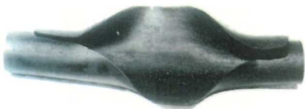
Rys. 2. Uszkodzenie wywołane ograniczeniem przepływu mieszanki parowo-wodnej
