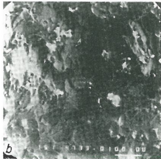
Rys. 6. Struktura ferryt + skoagulowany cementyt + płytkowo-iglaste układy węglików, o udarności 11,6 J/cm 2 (a) oraz przełom łupliwy o dużych powierzchniach rozdzielu (b)
