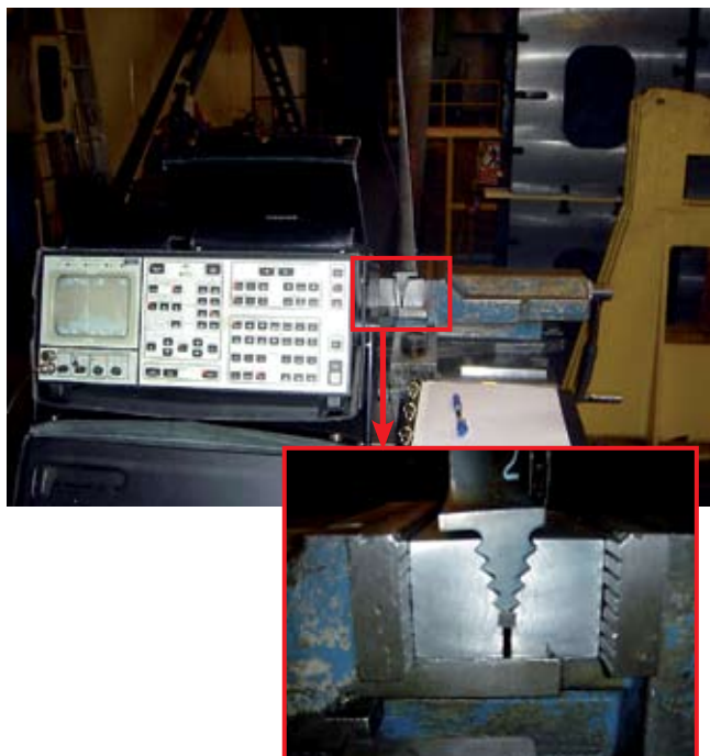
Rys. 4. Stanowiskowy pomiar częstotliwości drgań własnych łopatek
