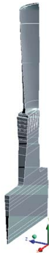
Rys. 11. Wycinek tarczy wirnikowej NP z łopatką ze stopką kołkowaną
