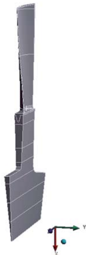
Rys. 12. Wycinek tarczy wirnikowej NP z łopatką ze stopką jodełkową prostą
