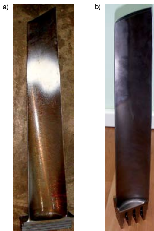
Rys. 3. Łopatki części niskoprężnych podobnych turbin: a) ze stopką jodełkową prostą, b) ze stopką kołkowaną
