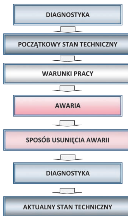
Rys. 1. Ocena stanu technicznego rur powierzchni ogrzewalnych – „klasyczne” podejście
