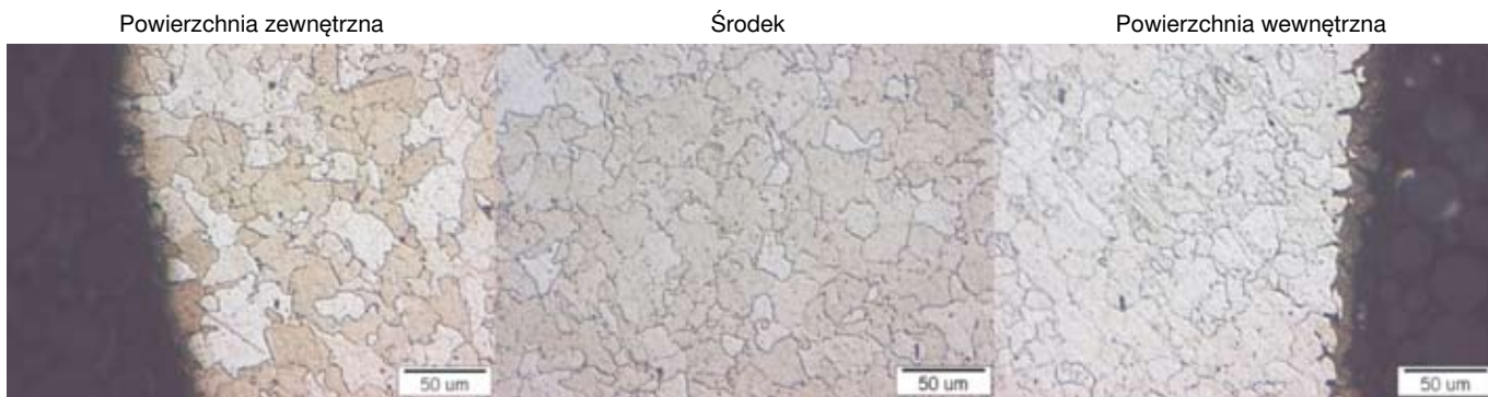
Rys. 6. Struktura korka na przekroju kolana, pow. 200x [10]
