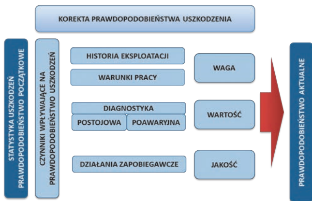
Rys. 9. Schemat wyznaczania bieżącej wartości prawdopodobieństwa awarii
