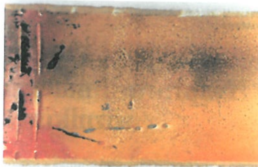
Rys. 2. Porażone pole z ubytkami erozyjnymi oraz brakiem warstewki ochronnej (pow. 2x)
